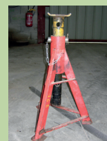
Chandelle de sécurité adaptée aux véhicules agricoles et industriels
