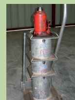
Cric 10 tonnes haute levée hydraulique ou pneumatique
